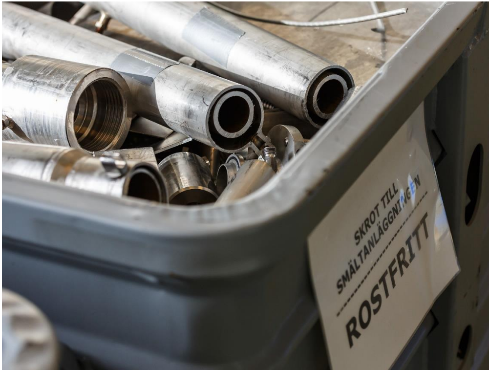
Figur 8 Utsorterad metall vid rivning, Källa: AB Svafo.
